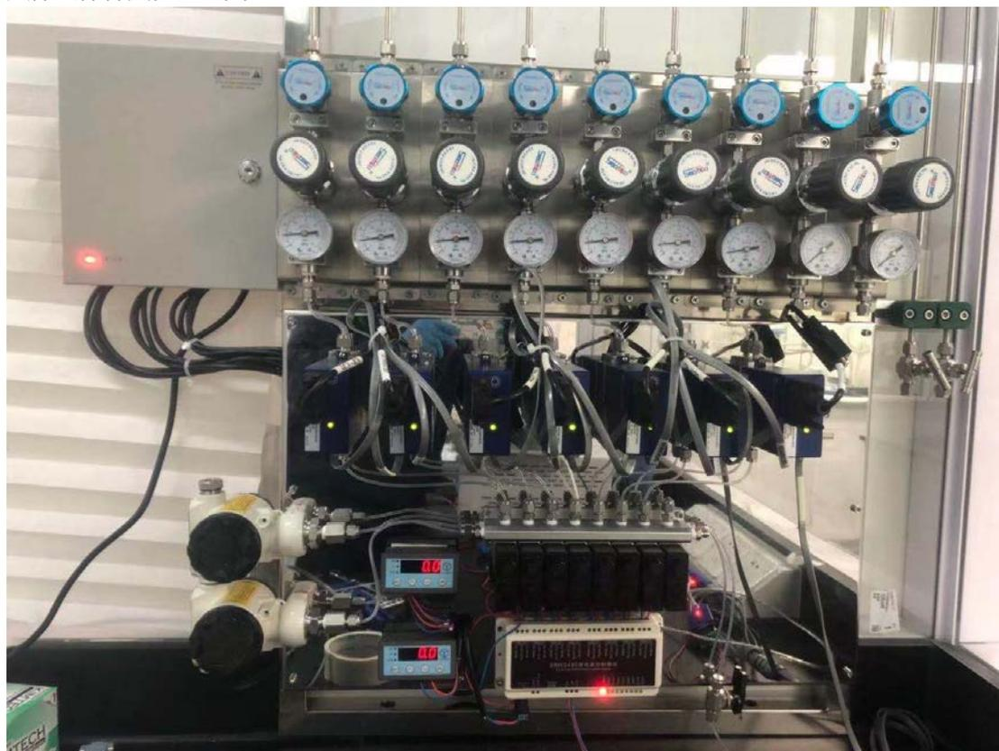
前 8 路气体接入质量流量计, 控制流量后进入电磁阀, 由电磁阀进行开合进入气路 A 与气路 B, 其中气路 A 在靠外的位置, 其压力表在上方, 同时气路 A 的气体为纯净的反应气体, 气路 B 在靠里的位置, 其压力表在下方, 并且气体为有流量计微漏的反应气, 使用应该根据实际情况选择。
