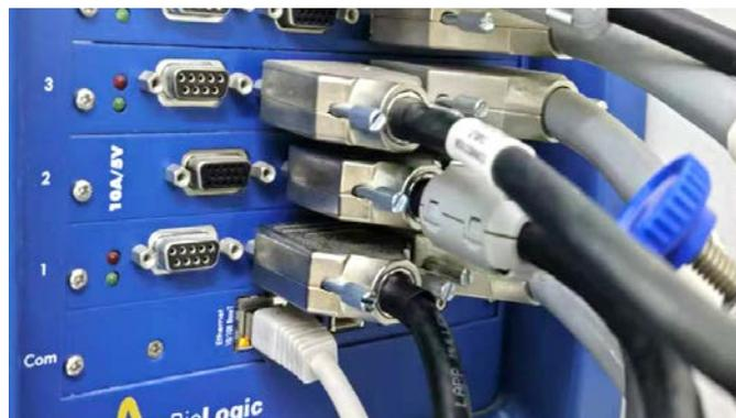
(2) 打开工作站，在 device 中先点击“-”把设备移除，后再点“+”重新加入设备。选中 channel 1，可以在底部的状态栏中看到“Amplifier: 5 V /10 A”，证明成功接好 booster 模块。
